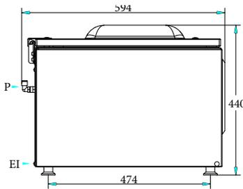
EI = Conexión eléctrica (energía)
